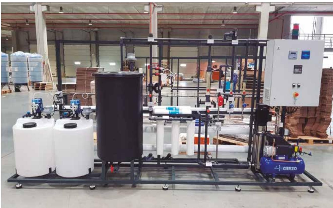
Planta de ósmosis inversa con una producción de 43 m<sup>3</sup>/d para la potabilización de agua de consumo en granja de pollos, instalada en Lérida.
