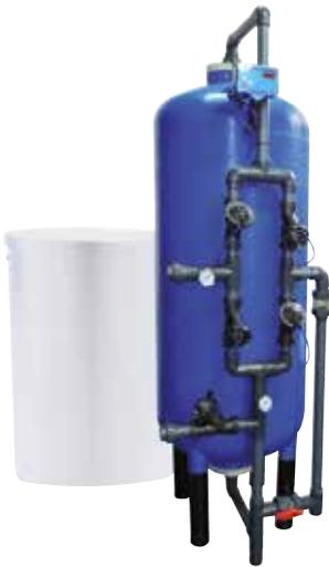
Equipos compuestos de botella de PRFV o poliamida con distribuidores superiores e inferiores y depósito de sal en polietileno. Batería de válvulas de diafragma automáticas, controladas mediante distribuidor hidráulico con programador electrónico. Contador con emisor de impulsos independiente.
