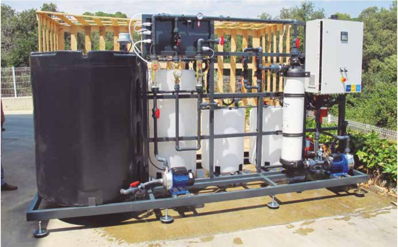
Planta de ultrafiltración de 4m<sup>3</sup>/h para la potabilización de agua de bebida, instalada en Uganda.
