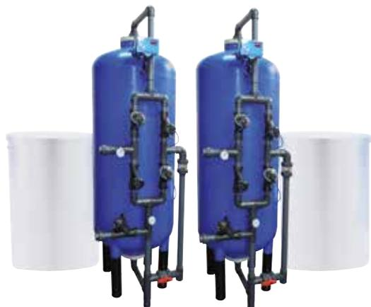
Equipos de doble columna de funcionamiento alterno (una en servicio y otra en regeneración) compuesto por dos botellas de PRFV o poliamida con distribuidores superiores e inferiores y depósitos de sal en polietileno.
